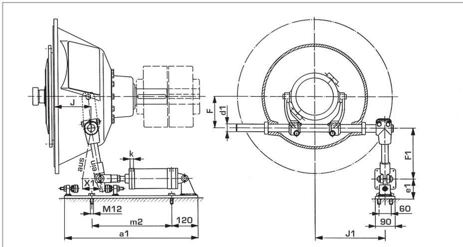
Abb. 16 Bauart SPA für Planox®-Kupplung PMA
