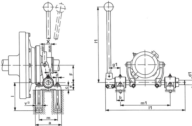
Abb. 12 Bauart SH für Planox® PMW und PMF
