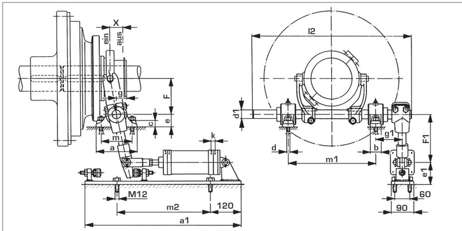
Abb. 15 Bauart SPWF für Planox®-Kupplung PMW und PMF
