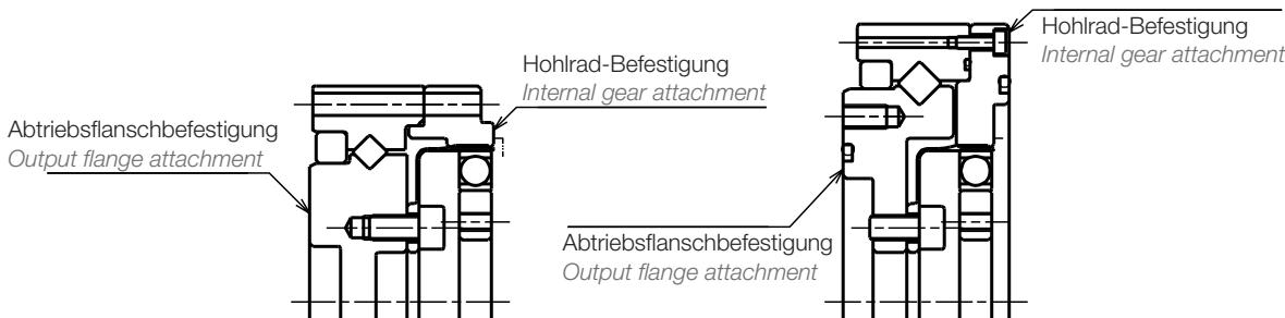
Schraubenspezifikationen und Drehmomentübertragung (offene Ausführung)
