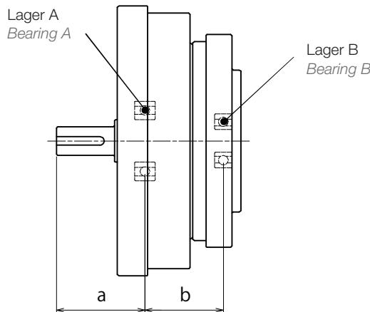
Maximale Last (durchschnittliche Antriebsdrehzahl: 2000 U/min, Lebensdauer: 7000 h)
