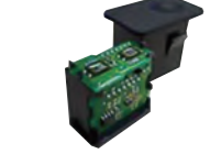
Sunbeam Autolight Sensor with ECU コントローラ内蔵日射・オートライトセンサ
